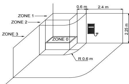
Vanno scrupolosamente rispettate le norme nazionali sull'installazione di apparecchiature elettriche nei locali da bagno. I radiatori elettrici vanno sempre installati al di fuori delle Zone 1 e 2. In particolare la presa di alimentazione, l'interruttore e gli organi di comando devono essere posizionati obbligatoriamente in zona 3, in modo che nessun organo di comando elettrico deve essere accessibile da una persona che utilizza la doccia o la vasca.
