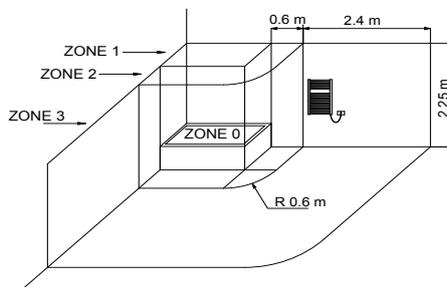
Vanno scrupolosamente rispettate le norme nazionali sull'installazione di apparecchiature elettriche nei locali da bagno. I radiatori elettrici vanno sempre installati al di fuori delle Zone 1 e 2.
