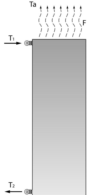
Il valore di riferimento di  $\Delta T$  è fissato a  $50^\circ\text{C}$  e la resa termica dei radiatori va determinata sperimentalmente presso laboratori accreditati secondo procedure fissate, anch'esse, dalla norma. Alla fine delle determinazioni sperimentali si arriva ad una relazione del tipo:
