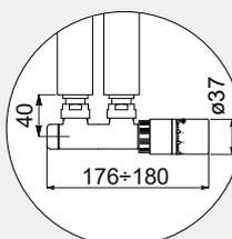
Misure per valvole interasse 50 mm a squadra dx con testa termostatica
