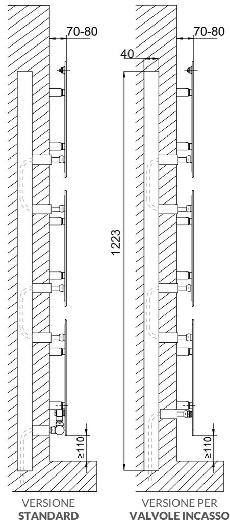
**SFERE TRITTICO** COMPLETO DI CORPO DA INCASSO A MURO PER IL COLLEGAMENTO IDRAULICO
