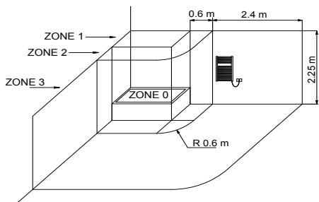
Vanno scrupolosamente rispettate le norme nazionali sull'installazione di apparecchiature elettriche nei locali da bagno. I radiatori elettrici vanno sempre installati al di fuori delle Zone 1 e 2. In particolare la presa di alimentazione, l'interruttore e gli organi di comando devono essere posizionati obbligatoriamente in zona 3, in modo che nessun organo di comando elettrico deve essere accessibile da una persona che utilizza la doccia o la vasca.
