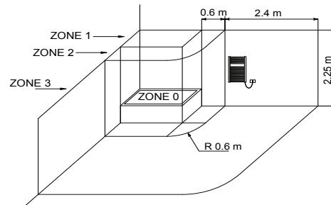
Vanno scrupolosamente rispettate le norme nazionali sull'installazione di apparecchiature elettriche nei locali da bagno. I radiatori elettrici vanno sempre installati al di fuori delle Zone 1 e 2.
