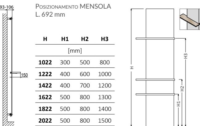
Nota: gli schemi di posizionamento si riferiscono alle diverse possibili opzioni di installazione per ciascun singolo componente acquistato.
