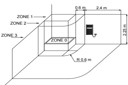
Vanno scrupolosamente rispettate le norme nazionali sull'installazione di apparecchiature elettriche nei locali da bagno. I radiatori elettrici vanno sempre installati al di fuori delle Zone 1 e 2.
