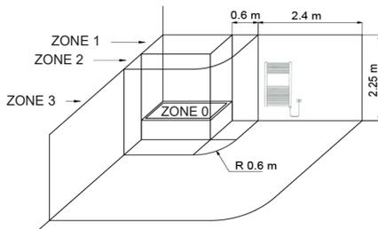
Positionner le radiateur de manière à ce que la distance minimale du plancher du thermostat soit de 250 mm et de manière à ce qu'aucun obstacle ne se trouve à une distance inférieure de 100 mm de l'appareil.
