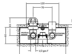
**KIT ROBINETS À ENCASTRER THERMOSTATISABLES – AVEC TÊTE THERMOSTATIQUE** pour raccords de type V14 - H08
