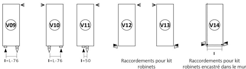
Le raccordement doit toujours être spécifié en phase de commande (V09 - V10 - V11 - V12 - V13 - V14).
