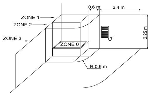
Les radiateurs électriques Cordivari sont dotés de résistances électriques de classe II avec indice de protection IP 44. Cela permet le montage en zone 2 de danger à condition que la ligne d'alimentation soit protégée par un interrupteur différentiel avec  $I_{dn} \leq 30\text{mA}$ . La prise d'alimentation et l'interrupteur différentiel doivent obligatoirement être positionnés en zone 3.
