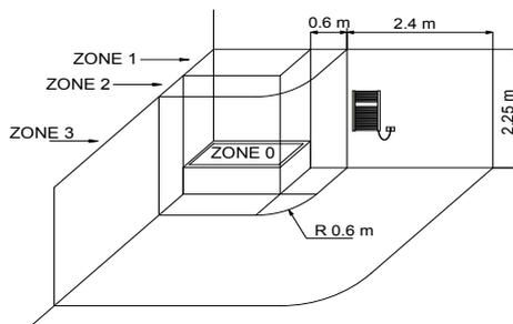
Les radiateurs électriques Cordivari sont dotés de résistances électriques de classe II avec indice de protection IP 44. Cela permet le montage en zone 2 de danger à condition que la ligne d'alimentation soit protégée par un interrupteur différentiel avec  $I_{dn} \leq 30\text{mA}$ .
