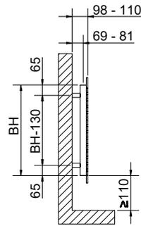
(\*) Der Befestigungssatz hat gleichen Nabenabstand wie der Heizkörper
