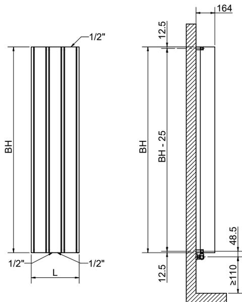
(\*) Der Befestigungssatz hat gleichen Nabenabstand wie der Heizkörper
