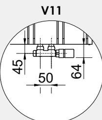
Abmessungen Ventilset Cordivari Elegant Eckform für Nebenabstand 50 mm mit Thermostatkopf rechts
