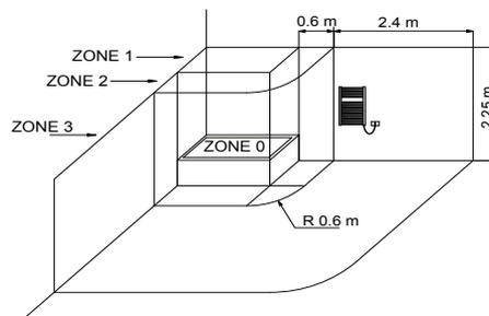
Die elektrische Heizkörper Cordivari sind mit Heizstäben der Klasse 1 und Mindestschutzgrad IP 44 ausgestattet. Dies ermöglicht den Einbau in die Gefahrenzone 2 mit Vorgabe, dass die Elektrische Leitung mit einem Differenzialschalter  $I_{dn} \leq 30$  mA versehen ist. Die Steckdose und der Differenzialschalter, müssen in der obligatorischen Gefahrenzone 3 positioniert sein.
