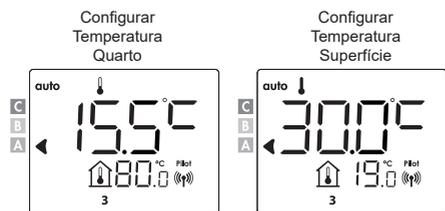
Ao premir ou será possível alterar temporariamente a temperatura desejada para, por exemplo, 18°C em caso de aquecimento com temperatura ambiente e, por exemplo, 45°C em caso de aquecimento com temperatura de superfície
