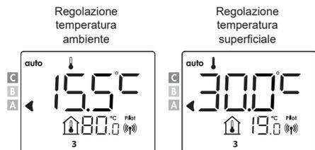
Premendo o si può cambiare temporaneamente la temperatura desiderata fino ad esempio 18°C in caso di riscaldamento con set-point temperatura ambiente e ad esempio 45°C in caso di riscaldamento con set-point temperatura superficiale
